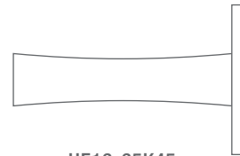
HF16-65K45 zur Verklebung Ø16 mm, Länge 71 mm
