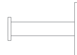
HSF1-L-K45 zur Verklebung Ø12 mm, Länge 63 mm
