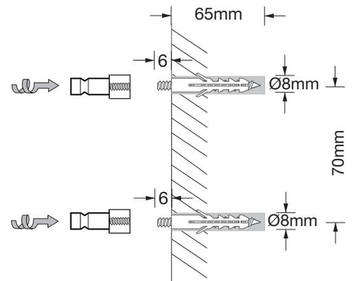
Hülsen mit festgedrehtem Steckadapter auf herausstehende Gewinde fest an die Wand drehen.
