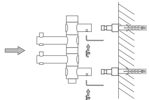
Vormontiertes Hakenelement auf die Wandadapter aufstecken und Madenschrauben mit Inbusschlüssel fixieren.
