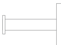
HSF1-L-K45-B zur Verklebung Ø12 mm, Länge 63 mm
