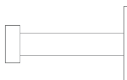
HSF2-L-R40-B zur Verschraubung Ø12 mm, Länge 65 mm
