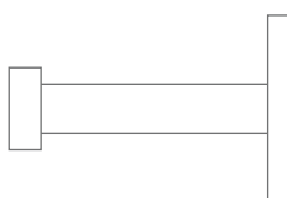
HSF2-L-K45 zur Verklebung Ø12 mm, Länge 68 mm
