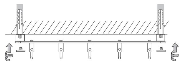
Befestigen Sie nun die Hakenleiste durch Aufdrehen der flachen Edelstahlschrauben auf die Hakenleiste an die Sockel. Für den öffentlichen Bereich empfehlen wir zur Sicherung der Schrauben etwas Klebstoff auf die Schraube vor dem Aufdrehen zu bringen.
