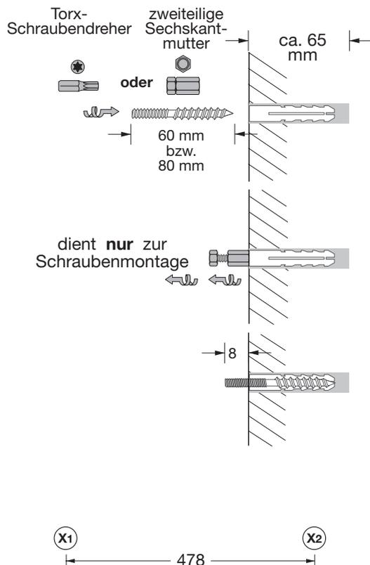
Unter Zuhilfenahme einer Wasserwaage 2 Bohrungen an X1 und mit Abstand von 478 mm an X2 vornehmen. Bohrerdurchmesser: 8 mm, Bohrlochtiefe: mindestens 60 mm. Sie können auch die Hakenleiste selbst zum Anzeichnen der Bohrlöcher verwenden.
