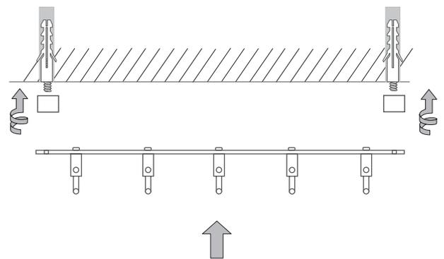
Sockel der Hakenleiste auf die herausstehenden Gewinde der Stockschrauben fest bis zur Wand aufdrehen. Dann Hakenleiste auf diese Sockel halten.
