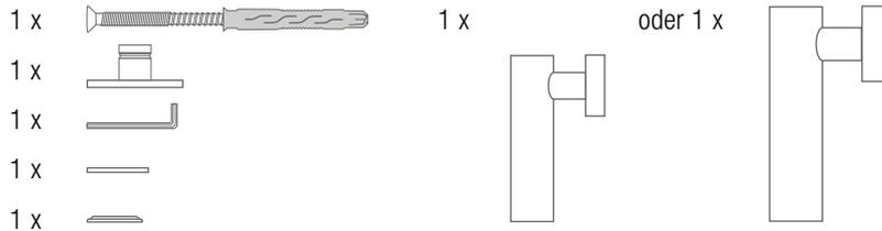
**▲ HINWEIS** Die Haftkraft des integrierten Magneten bei TFM20-77 beträgt ca. 25 kg (ca. 245 N). Die Haftkraft des integrierten Magneten bei TFM25-100 ca. 39 kg (ca. 382 N).
